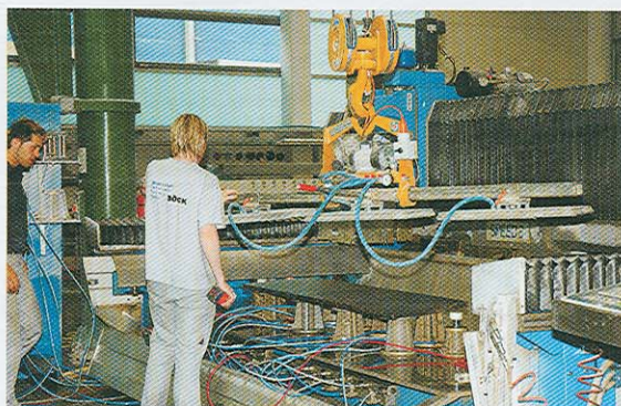
High-Tech im Steinmetzbetrieb: Eine Hochdruckwasserstrahlanlage von Tecnocut und ein Bearbeitungszentrum von CMS Brembana.
